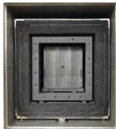
HTK 8 GR/22: Kammerofen mit einem nutzbaren Volumen von 8 l und einer maximalen Temperatur von 2200 °C. Die Isolierung besteht aus mehreren lagen Graphitfilz. Im Ofen befindet sich eine rechteckige Retorte.
